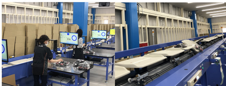
自動ソーター2機で、 1時間に10,000個商品を最大200箇所仕分けが可能
