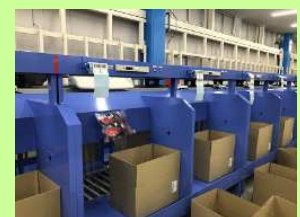
自動ソーター （1時間に約10,000個の 仕分けが可能）
