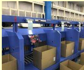
自動ソーターにより1時間に約10,000個の商品の仕分けを実現
