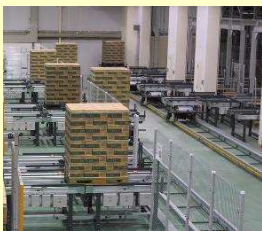
自動ラック倉庫により10,624パレットの収納を実現
